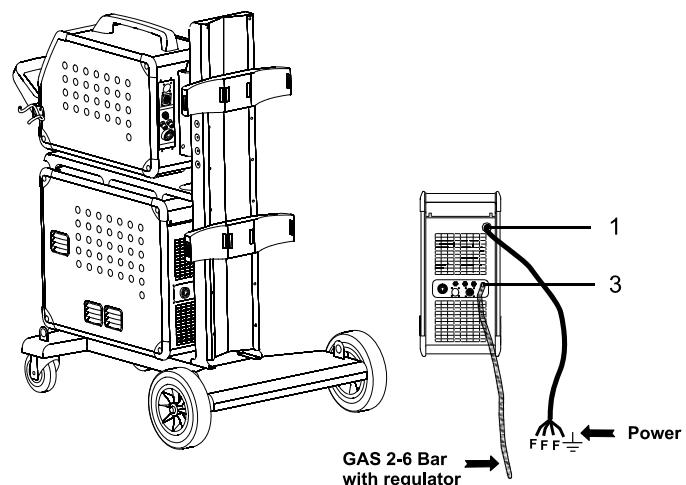
Importante: extender las mangueras externas de soldadura, cable de masa y manguera de interconexión como se muestra en la figura para evitar afectar el funcionamiento de la soldadura y en el peor de los casos la avería de la máquina de soldadura.
