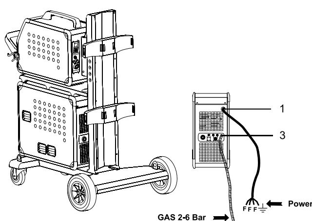
Ważne: rozciagnij wąż spawalniczy, przewód uziemienia oraz przewód połączeniowy w sposób ukazany na rysunku, w celu uniknięcia niekorzystnego wpływu na jakość spawania, lub nawet zniszczenia spawarki.
