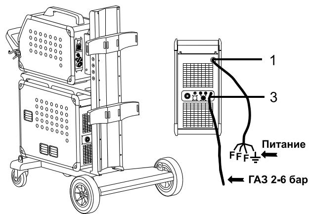
Важно: протяните сварочный шланг, кабель заземления и соединительный кабель, по мере необходимости, как показано на рисунке, во избежание снижения рабочих показателей и, в худшем случае, повреждения сварочного аппарата.
