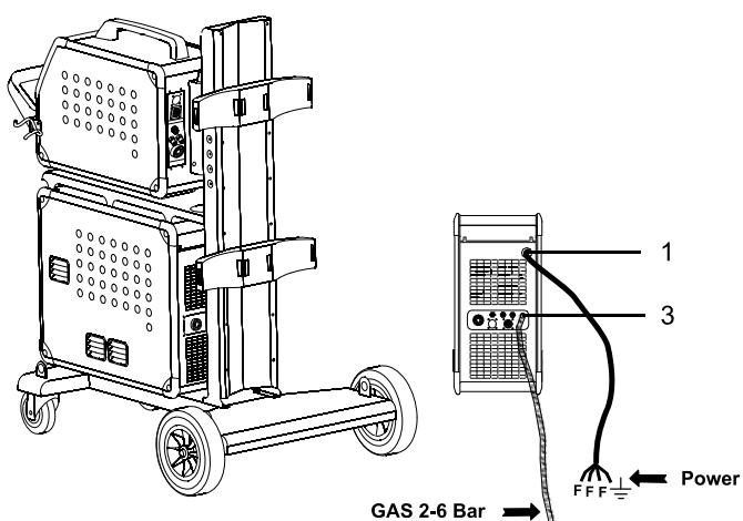
Importante: srotolare, se necessario, la torcia di saldatura ed il cavo di massa, come mostrato in figura, per evitare un peggioramento della saldatura e, nel caso peggiore, di danneggiare l'impianto.
