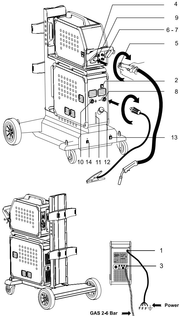
Wichtig: Schweißschlauch, Massekabel und eventuell Zwischenschlauchpaket ausbreiten wie in Abbildung gezeigt um Beeinträchtigung der Schweißleistung und schlimmstenfalls Zerstörung der Schweißmaschine zu vermeiden.
