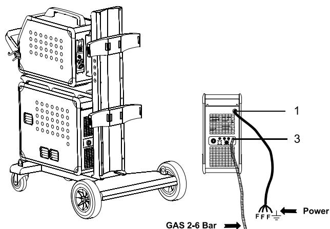
Fontos: hegesztő, test és köztes kábeleket az ábra szerint terítsük ki, hogy a hegesztő teljesítmény csökkenését és legrosszabb esetben a hegesztőgép károsodását elkerüljük.
