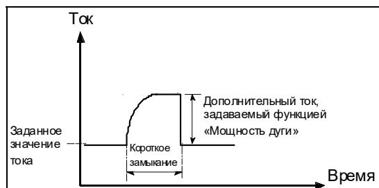
Значение мощности дуги можно регулировать в диапазоне от 0 до 100% заданного сварочного тока.
