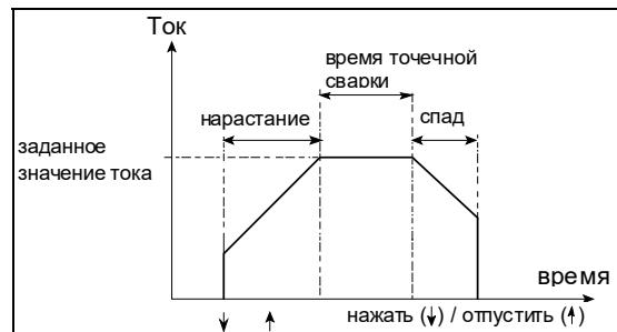
Установите значение таймера до зажигания дуги. В зависимости от выбранного типа горелки триггер горелки позволяет прервать точечную сварку. Регулируется в промежутке от 0 до 20 секунд: с шагом от 0,5 с и 0,1 с при больших значениях. При выставлении времени на ноль функция отключается. При сварке прихваточным швом можно выставить значение таймера от 0,01 до 2,5 с (см. «TIG-A-TACK»).
